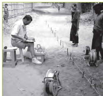
Géophysique (panneau électrique en Afrique)
