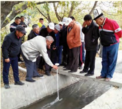
Figure 11 : Mirabs au Kirghizstan testant le dispositif « SmartStick » pour mesurer les niveaux d'eau.
